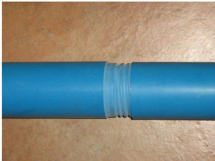
Slika 2 "Flush joints" navoji. Enoten premer cevi.
