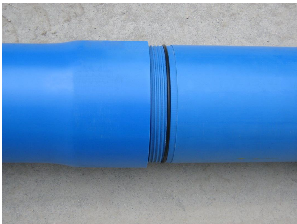
Slika 1 M/F navoji z odebelitvijo na spojnici. Ta način zahteva večji premer vrtanja in ni primeren za ODEX ali podobne sisteme vrtanja.
